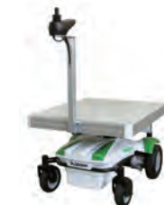
Target Guided Autonomous Robot 跟踪搬运机器人 "THOUZER" 是株式会社Doog的产品
